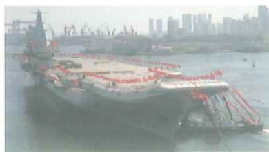
(d) 中国首艘国产航母山东舰的推进功率可达 1.47 \times 10^5 \text{ kW}
