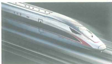
(c) “复兴号”动车组（时速 350 \text{ km} ）的功率可达 10\,000 \text{ kW}
