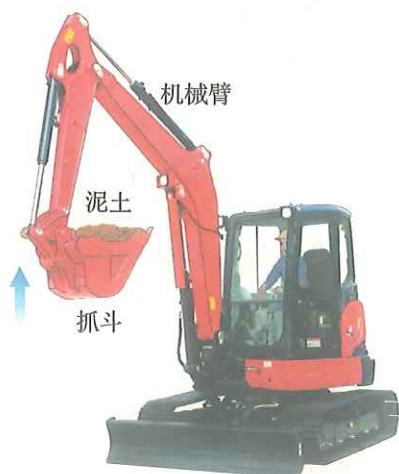
(b) 利用挖掘机挖掘、搬运泥土
