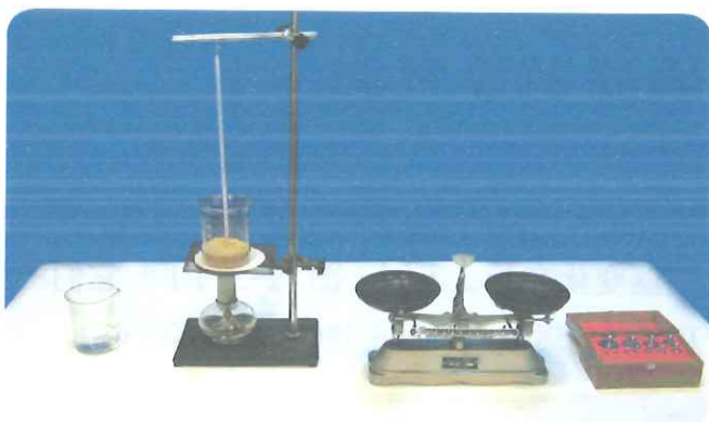
图 12-3-2 探究水和砂石吸热、放热性能的实验器材
